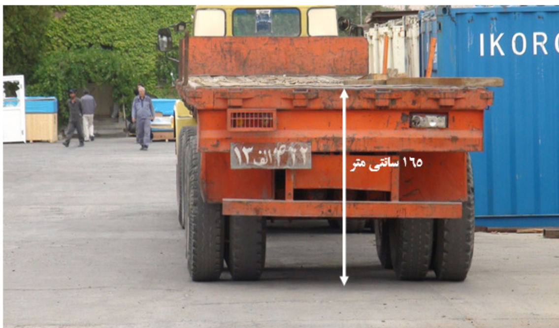
شکل ۴ نمایی از دستگاه تریلی برخورد کننده با لیفتراک و ارتفاع کفی آن از سطح زمین
